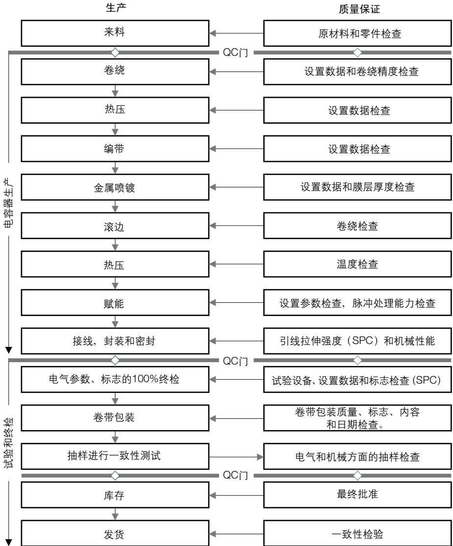
图2 生产过程中的质量保证 (卷绕薄膜电容器)
